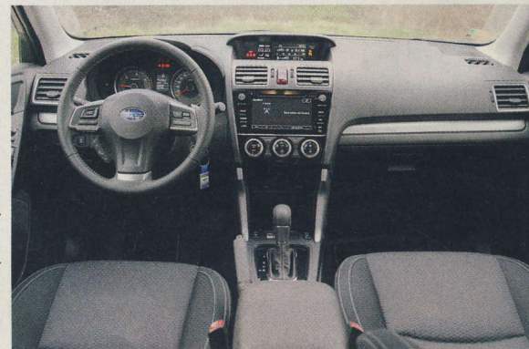
Hladce pracující variátor nabízí i sportovní mód se sekvenčním řazením sedmi stupňů
