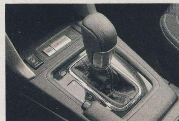
Hladce pracující variátor nabízí i sportovní mód se sekvenčním řazením sedmi stupňů
