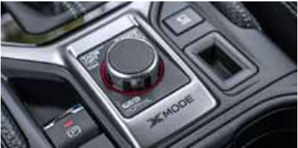
Všechny tři modely jsou vybaveny dvoustupňovým režimem X-Mode, který přizpůsobuje činnost motoru, pohonu všech kol a dalším systémům různému povrchu pod koly
