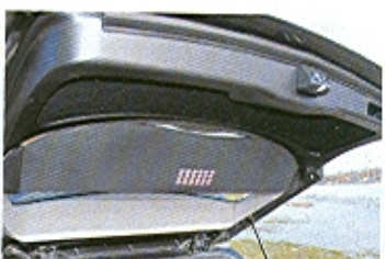
Importér zakomponoval do pátých dveří přídatný kryt, který po jejich zavření nedovoluje pohled do zavazadlového prostoru. Jak prozřívá proti nenechavcům.
