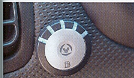
Přepínání pohonné hmoty i množství plynu v nádrži zajišťuje spínač s diodami
