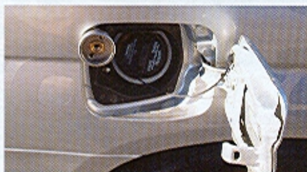
Hrdlo pro tankování plynu je ukryto pod stejnými dvířky jako hrdlo benzinové nádrže, ovšem je nutné našroubovat krátký nástavec
