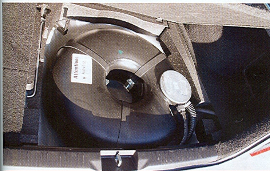
Místo rezervního kola je nyní toroidní nádrž na plyn o obsahu 55l
