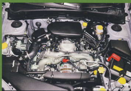
>> Atmosféricky plněný čtyřválcový boxer 2,5 litru jde proti dnešním trendům, což však není na škodu
